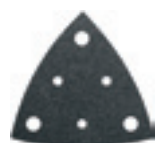
Arkusze papieru ściernego z cyrkonu Z otworami, szybkie mocowanie na rzep. Do szlifowania z odciągiem lub bez odciagu pyłu. Doskonała wydajność ścierna przy szlifowaniu bardzo twardych powierzchni, np. lakierowanego parkietu lub metalu. Papier ścierny do wszystkich prac przy układaniu podłóg. Bardzo stabilny papier dzięki ciężkiemu spoiwu z żywicy syntetycznej i wysokiej jakości nasypowi korundowo-cyrkonowemu.
