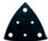
Arkusze papieru ściernego, z otworami Do szlifowania z odciągiem pyłu. Do uniwersalnego zastosowania na prawie wszystkich powierzchniach. Korundowe ziarno ściernie w spoiwie na bazie żywicy syntetycznych gwarantuje wysoką wydajność ścierną. Ziarnistość od 36 do 240.
