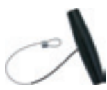
Linka przeciągowa z rączką. Zalecana do cięcia od zewnątrz nożem tnącym hakowym lub w kształcie litery L. Umożliwia pracę z mniejszym naciskiem przy wycinaniu szyb w autobusach, samochodach ciężarowych i pojazdach szynowych w miejscach trudno dostępnych.
